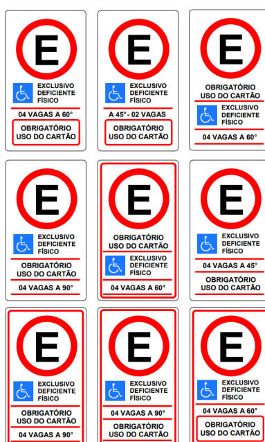
Figura 27 - Modelo de sinalização vertical para veículos que transportem pessoas portadoras de deficiência e com dificuldade de locomoção
